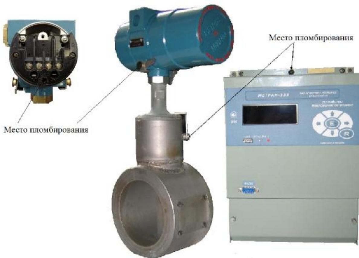
Рисунок 1 – Общий вид счетчика
